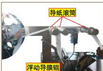
3、将膜穿过导纸滚筒，穿过浮动导膜辊
