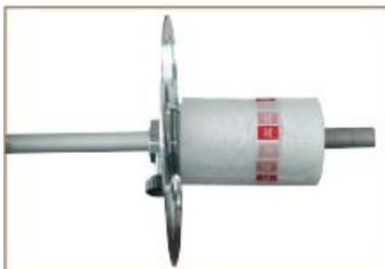
1、将膜套入薄膜挡圈中
